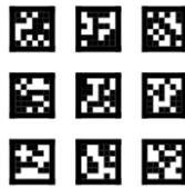
Figure 3. Exemple d'AprilTags (type 36h11) générés par OpenCV.
