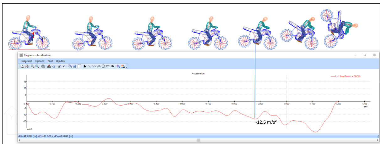
Figure 7 : Simulation numérique du stoppie avec le logiciel PC CRASH (V= 50 Km/h - Masse moto = 234 Kg – Masse Pilote = 88 Kg)
