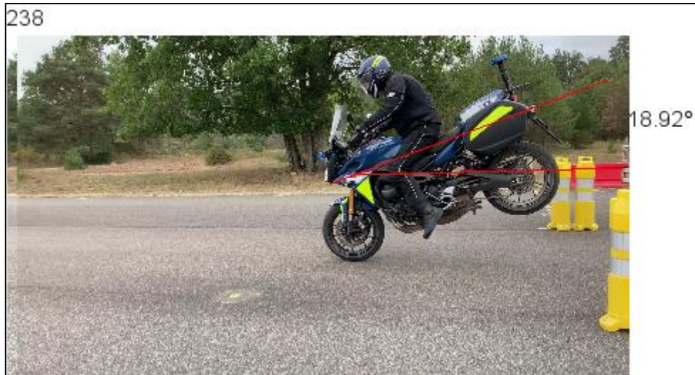
Figure 6: Vue de la mesure du tangage de la motocyclette YAMAHA TRACER 900 lors de l'essai 238 (cf. courbe en Annexe)
