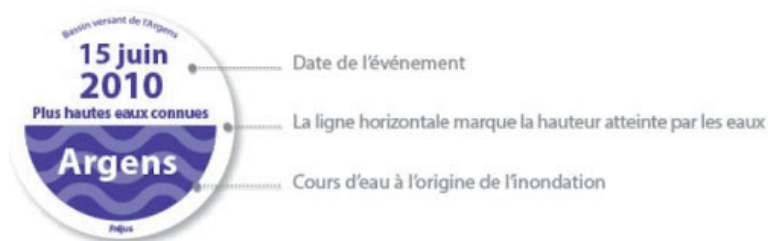
Normalisation des repères de crues
