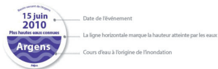
Normalisation des repères de crues
