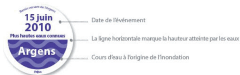
Normalisation des repères de crues
