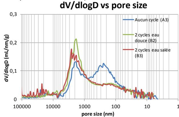
Figure 7. Courbes porosimétriques du matériau
