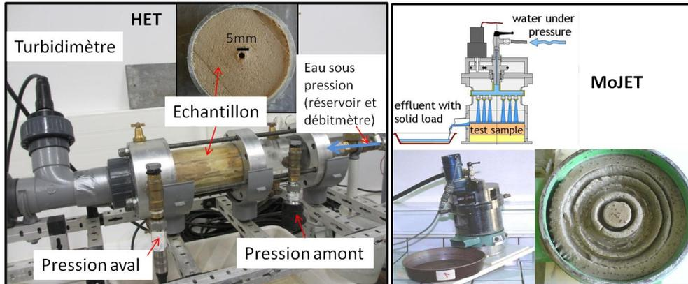
Figure 5. Dispositifs expérimentaux pour l'étude de l'érosion interne, à gauche (HET), et de l'érosion externe, à droite (MoJET)
