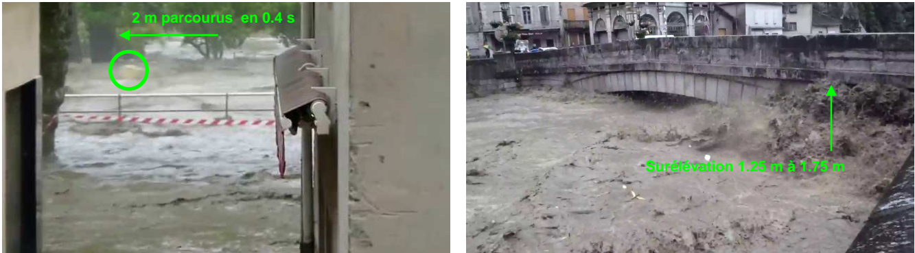
Figure 2. Exemples d'estimations ponctuelles de vitesse d'écoulement de surface réalisées à partir de vidéos à Bossost (à gauche) et Saint Bât (à droite) sur la Garonne, confirmant des ordres de l'ordre de 5 m/s.
