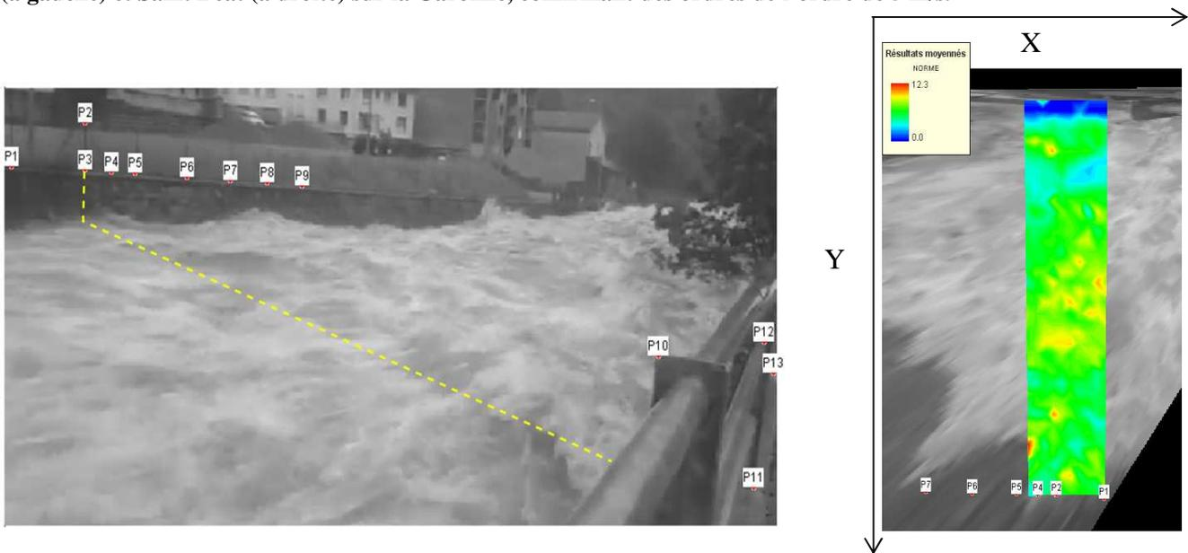
Figure 3. Exemple d'estimations de champs de vitesses de surface à Caunterets sur le Gave de Caunterets (source Raphael Le Boursicaut, Irstea). La vitesse de surface moyenne est estimée à 5 m/s, avec un maximum à 6,9 m/s.
