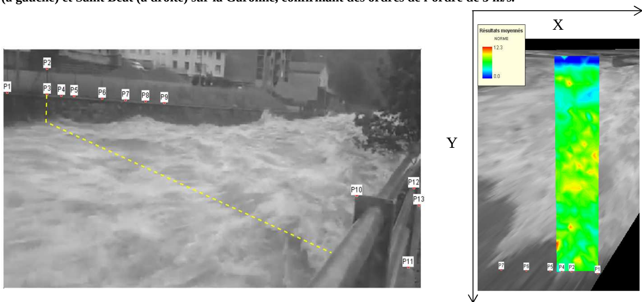
Figure 3. Exemple d'estimations de champs de vitesses de surface à Cauterets sur le Gave de Cauterets (source Raphael Le Boursicaut, Irstea). La vitesse de surface moyenne est estimée à 5 m/s, avec un maximum à 6,9 m/s.
