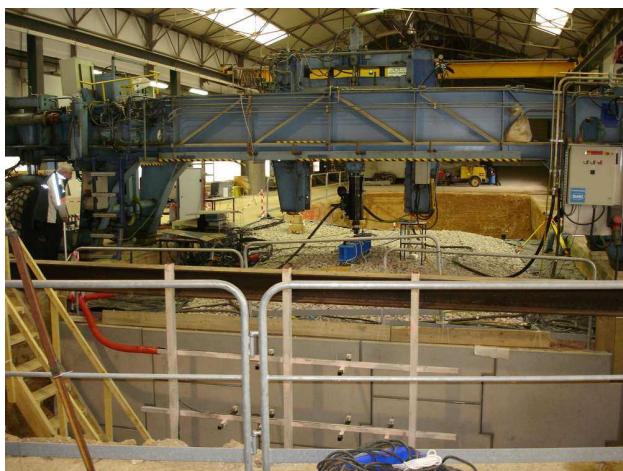
Figure 4. Portique de chargement au dessus de la structure Terre Armée.
