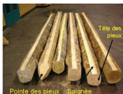
Figure 2 . Saignée dans les pieux
