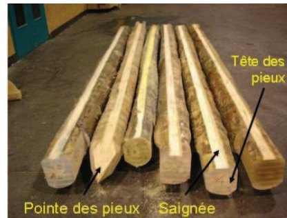
Figure 2 . Saignée dans les pieux
