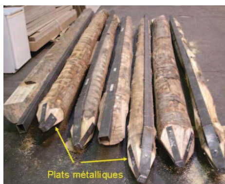
Figure 6. Protection de la pointe à l'aide de plats métalliques
