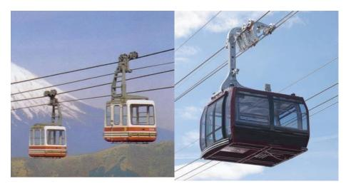
Figure 6: Bicâbles et tricâble détachable Gondola
