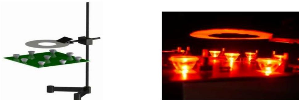
**FIGURE 9 : LLUSTRATION DES ESSAIS DE MATÉRIAUX DIFFUSANTS**
