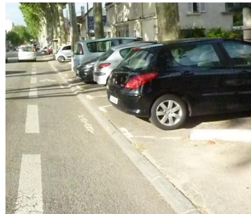
Figure 16 : Véhicules garés en bataille en marche avant : aucune visibilité des conducteurs en sortant
