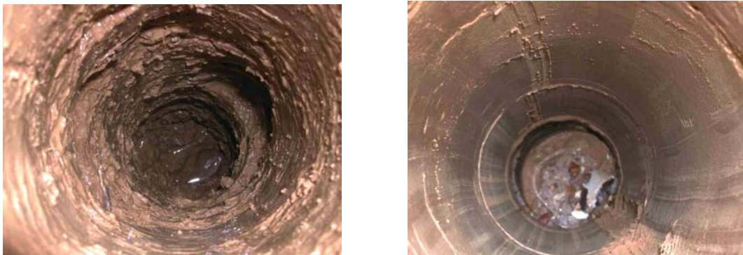
Figure 16 Trou après essai de la trousse au CER de Rouen cas de surforage à gauche et conditions correctes à droite
