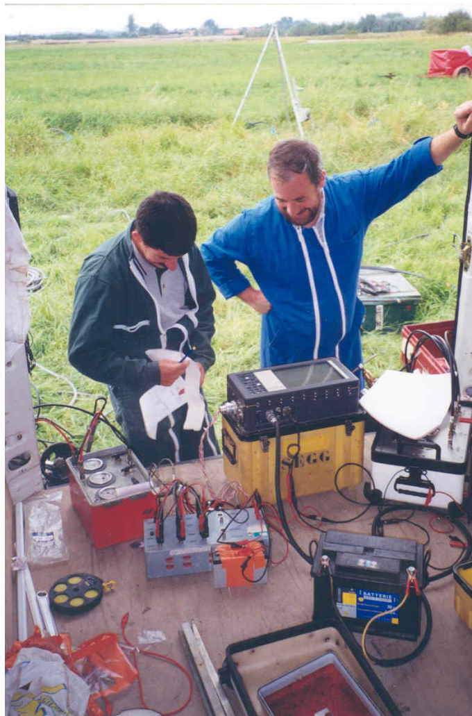
Figure 16 Réalisation des essais cross-hole
