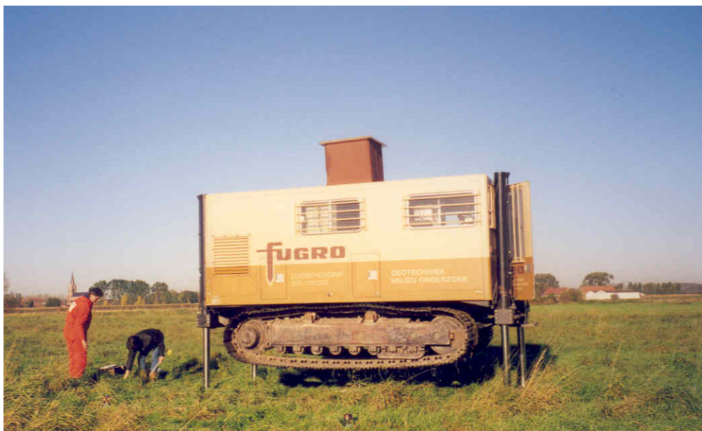
Figure 17 Réalisation des pénétromètres
