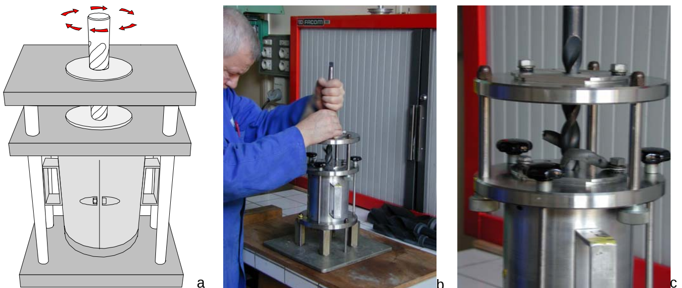
Figure 12. Principe du creusement : a) mise en œuvre ; b) perçage manuel ; c) zoom de la photo précédente.
