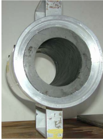
Figure 13. Éprouvette de sol naturel après creusement
