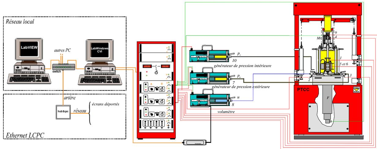
Figure 6. Schéma fonctionnel de la presse triaxiale pour éprouvettes cylindriques creuses (PTCC) du LCPC
