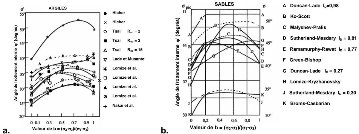
Figure 24. Valeurs de l'angle de frottement interne  $\phi$  en fonction du paramètre  $b$  de la contrainte principale intermédiaire au vrai triaxial et au cylindre creux : a) pour les argiles ; b) pour les sables (d'après Biarez et Hicher [46])
