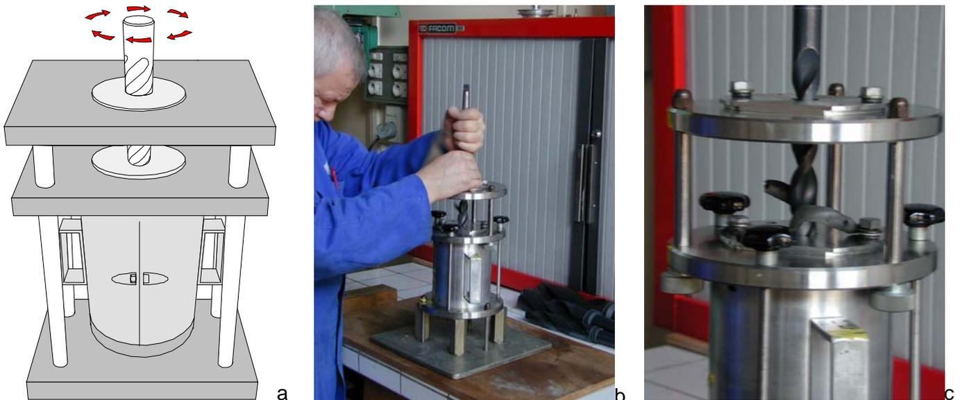
Figure 12. Principe du creusement : a) mise en œuvre ; b) perçage manuel ; c) zoom de la photo précédente.
