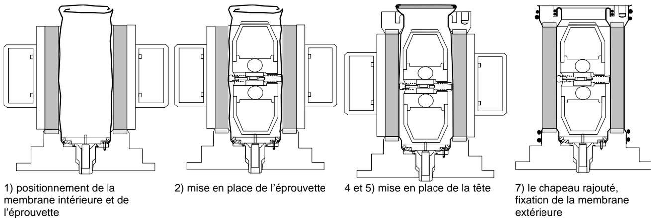
Figure 15. Procédure pour le montage de l'éprouvette
