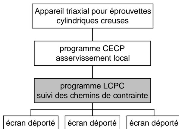
Figure 19. Architecture de l'asservissement (PTCC du LCPC)
