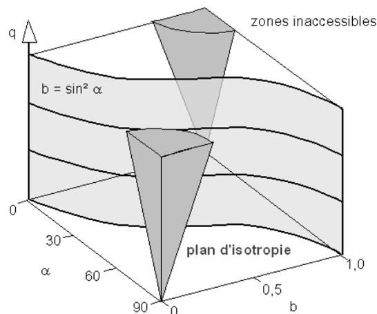
Figure 3. Potentiel des appareillages (avec  $q$  contrainte déviatorique définie dans le tableau 1)
