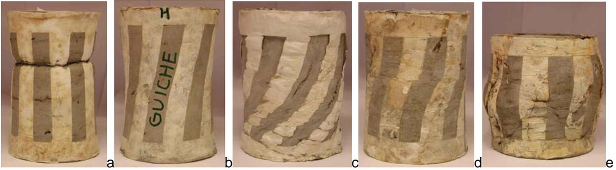
Figure 23. Exemples de modes de rupture obtenus pour l'argile de Guiche : a) extension ; b) extension et cisaillement ; c) cisaillement ; d) cisaillement et compression ; e) compression (PTCC du LCPC)
