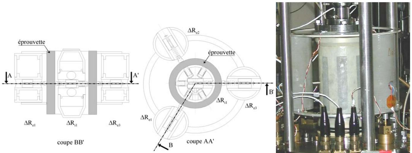
Figure 9. Disposition des capteurs intérieurs et extérieurs (PTCC du LCPC)
