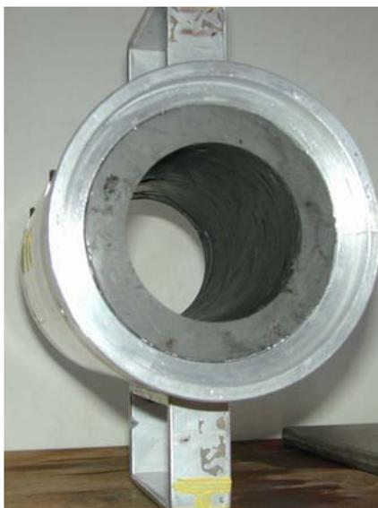
Figure 13. Éprouvette de sol naturel après creusement
