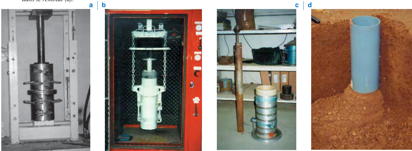
figure 10 Éprouvettes reconstituées par compactage statique (a), vibro-compression (b), dame Proctor (c) et taillées dans le remblai (d).
