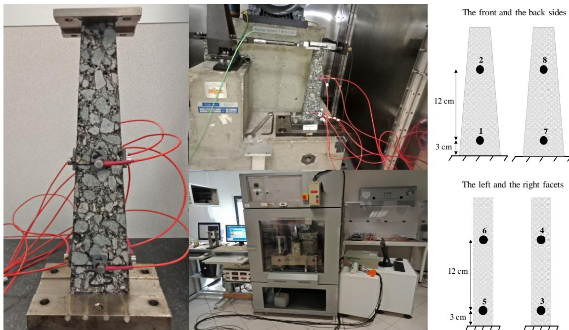
Figure 8. Dispositif expérimental pour l'essai mécanique et implantation des capteurs
