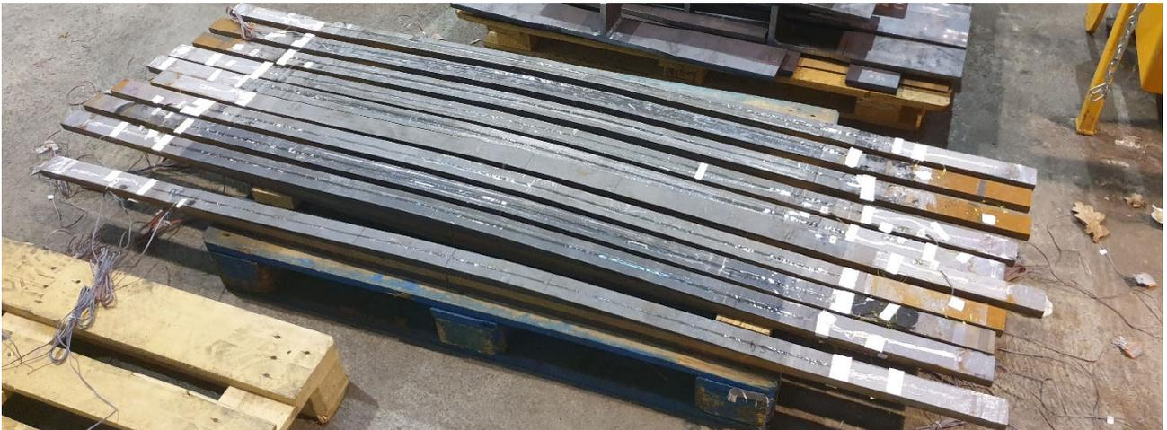
*Fig. 3. Eprouvettes après découpe au jet d'eau.*
