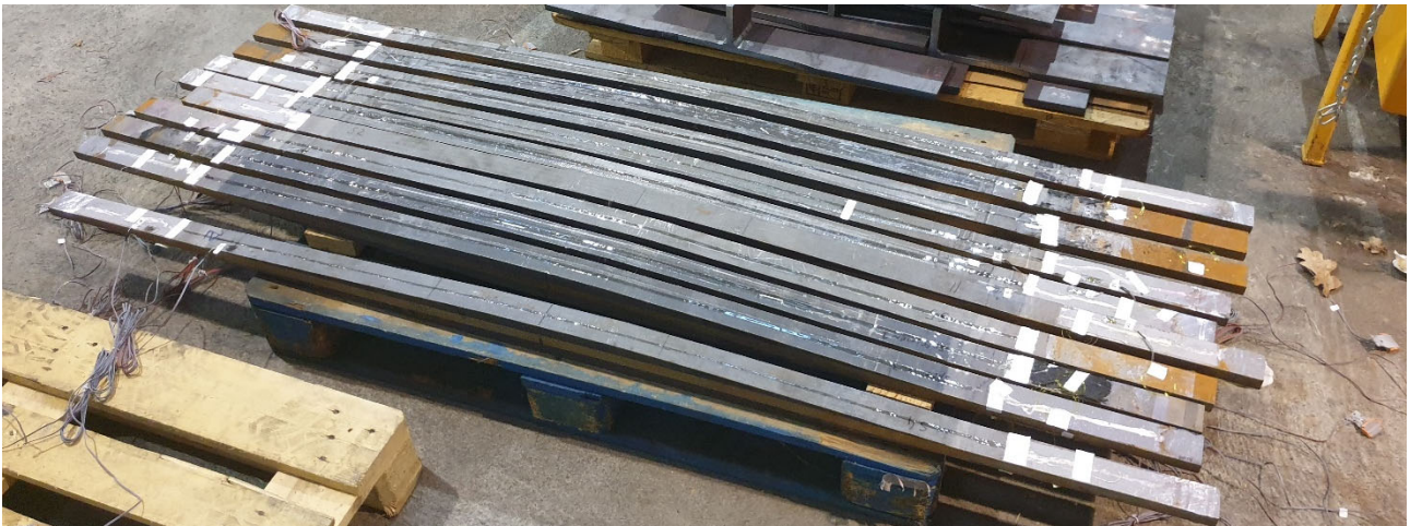
Fig. 3. Epreuves après découpe au jet d'eau.
