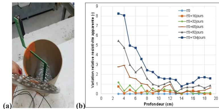
**Figure 3.** (a) Photo du capteur et des grilles dans une éprouvette 11x22 cm avant coulage, (b) Variation relative de la résistivité apparente pour la CIT en fonction de la profondeur lors du séchage.
