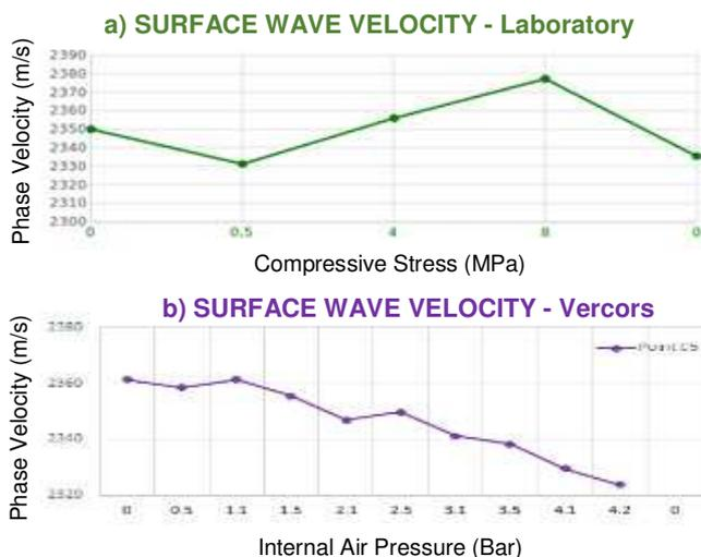
**FIGURE 4:** EVOLUTION OF SURFACE WAVE VELOCITY a) VERSUS STRESS, b) VERSUS INTERNAL AIR PRESSURE
