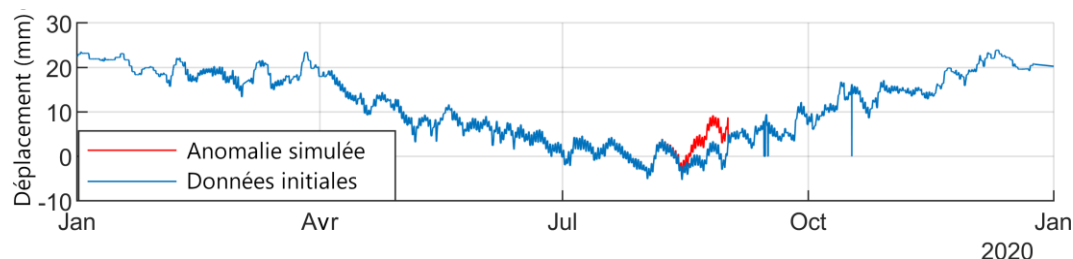
FIGURE 5. Anomalie appliquée sur un capteur d'entrée dans le scénario n°3
