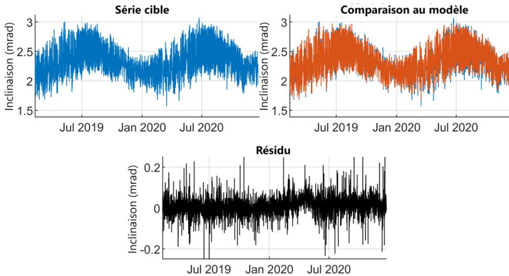
**FIGURE 3.** Illustration d'un modèle RNN d'un inclinomètre
