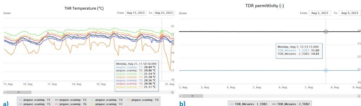
FIGURE 7. Exemple de suivi des mesures pré-traitées dans le logiciel STOCO - a) Températures (T4 extérieure) - b) Permittivité des TDR
